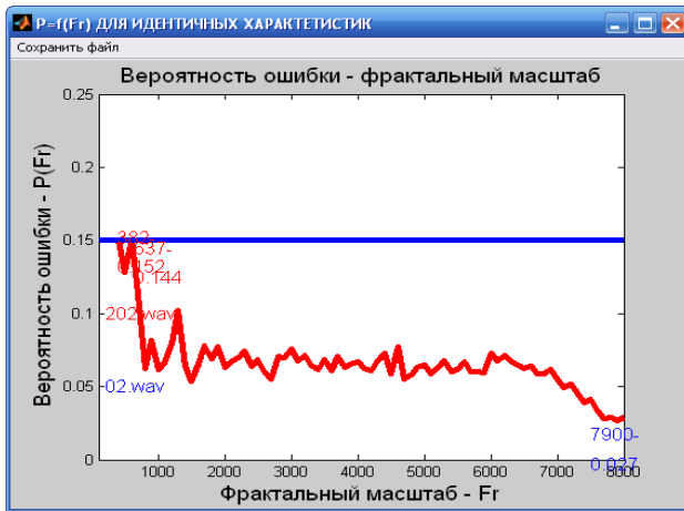
Рис. 3.14. Вікно результатів визначення фрактальних масштабів ЕФ і СФ у області зі збігом характеристик
