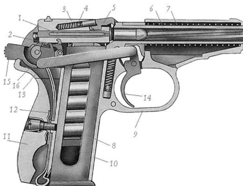
Рис. 1. Основні частини пістолета Макарова: 1 – ударник; 2 – шептало; 3 – затвор; 4 – пружина викидача; 5 – викидач; 6 – ствол; 7 – зворотна пружина; 8 – магазин; 9 – спускова скоба; 10 – рамка; 11 – рукоятка; 12 – бойова пружина; 13 – спускова тяга; 14 – спусковий гачок; 15 – курок; 16 – важіль взводу.
