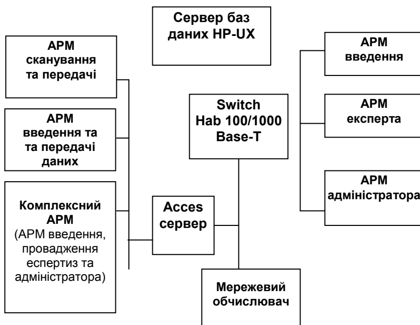
Мал. 17. Структурна схема АДІС "Дакто 2000"
