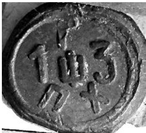
Рис. 2.3. Відтиск на верхній пломбі лічильника
