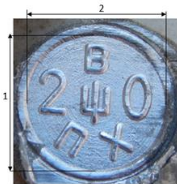
Рис. 2.1. Виміри основних розмірних х-к відбитка матриці пломбувальних лещат
