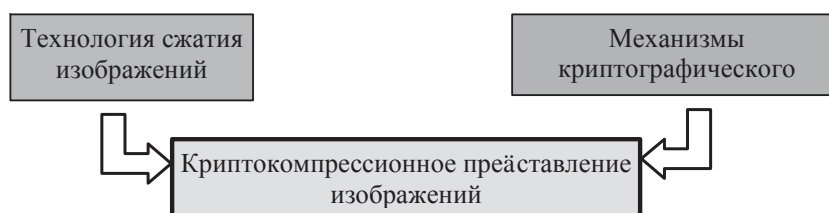
Рис. 1. Схема подхода для создания криптокомпрессионного представления с ключом
