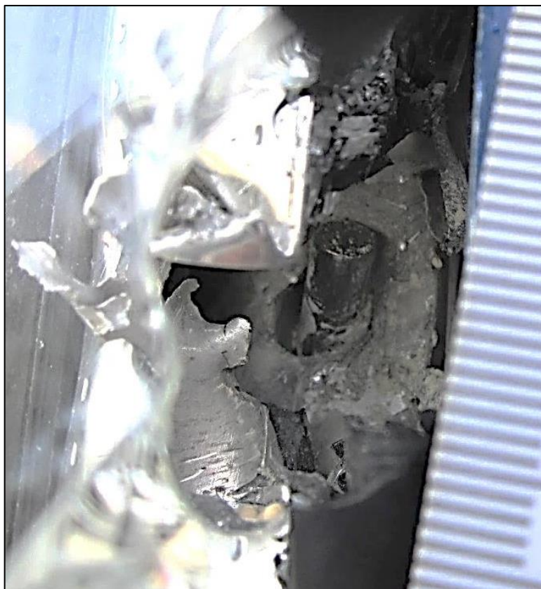
Рисунки 14. Збільшене зображення сліпого вогнепального пошкодження в стойці метало-пластикового склопакету із стальним сердечником кулі калібру 7,62мм.
