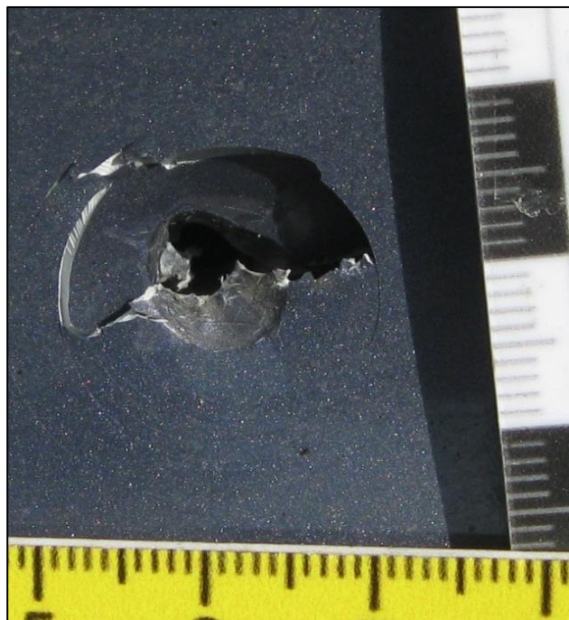
Пошкодження на полімері.
