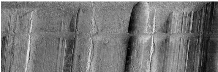
Рис. Розгортка бічної поверхні кулі, отримана шляхом лазерного сканування за допомогою балістичної системи «Рикошет»
