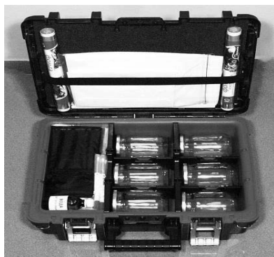
Рис. 2. Одорологічна валіза ОВ-1
