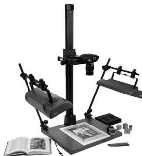
Рис. Репродукційна фотографічна установка
