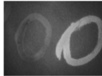
Рис. Виявлення відмінностей в інтенсивності ІЧ-люмінесценції чорнила (візуалізація дописок і виправлень в документах)
