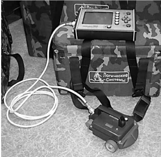
Рис. 16 Георадар типу «ОКО» с антенним блоком АБ-1700 і блоком обробки як регістратор сигналу
