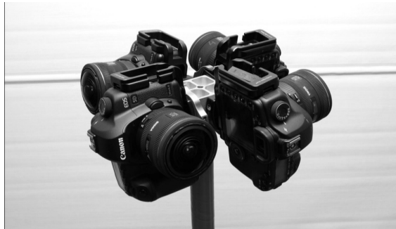
Рис. 50. Фотокамери Canon EOS 5D mark II з ширококутними об'єктивами на спеціальній конструкції для сферичної відеозйомки
