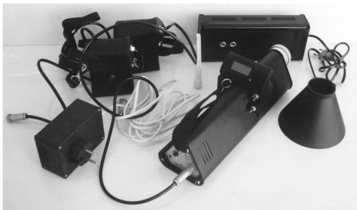
Рис. 12. Портативний детектор вибухових речовин «МО-2»
