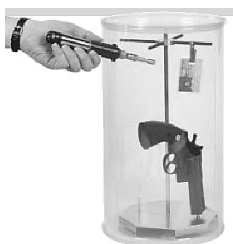
Рис. 33. Поліетиленова камера для обробки об'єктів парами ціаноакрилу з використанням газового пальника
