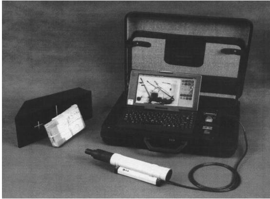
Рис. 9. Переносний цифровий рентгенівський комплекс «Колибри-50ЦФ»
