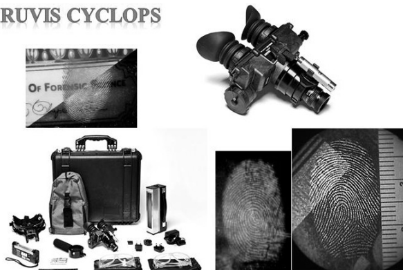
Рис. 27. Система RUVIS CYCLOPS для візуалізації слідів без попередньої їх обробки
