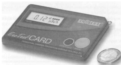
Рис. 19 Дозиметр гамма-випромінювання індивідуальний ДКТ-21 «Ecotest CARD»
