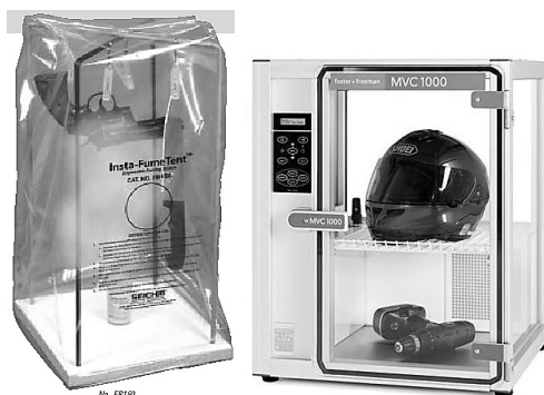
Рис. 32. У ціаноакрилових камерах без використання вакууму та з використанням вакууму.
