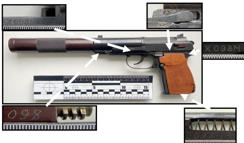
Ілюстрація № 2. Маркувальні позначення на деталях пістолету ПБ.
