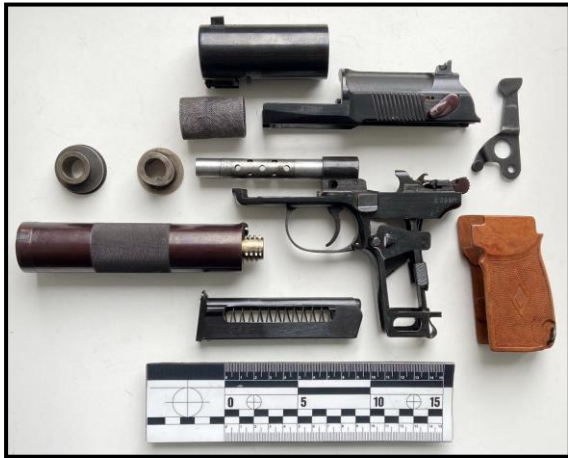
Ілюстрація № 1. 9,0-мм самозарядний пістолет для безшумної та безполум'яної стрільби ПБ та його основні частини.
