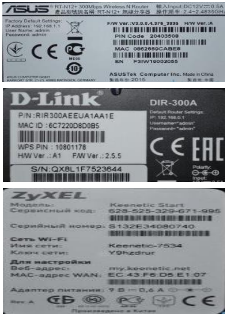
Рис. 2. Загальні дані роутерів різних моделей, що знаходяться на зворотній їх частині.
