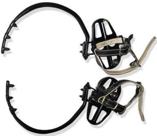
Електромонтанжні «кігті» та спеціальний пасок для підняття на електроопору
