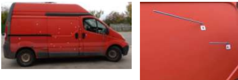
Рисунок 1-2. Кульове пошкодження на автомобілі та проведення візування.
