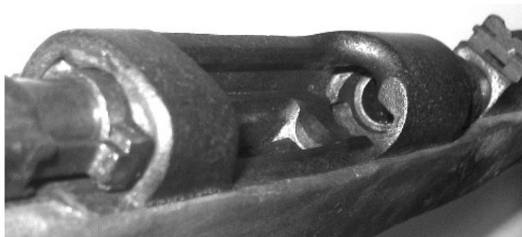
Іл. №6. Вид на вікно ствольної коробки , затвор у крайньому задньому положенні, набійник пустий
