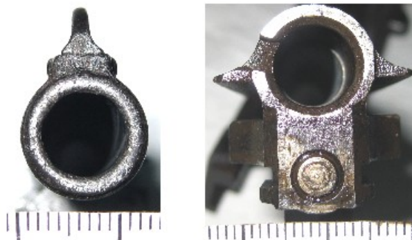
Іл. №17, 18. Дульний та казенний зрізи ствола
