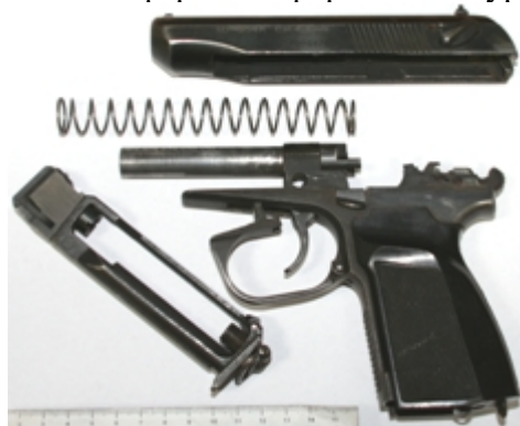
Іл. №5: Зображення предмета, схожого на пістолет, наданого на дослідження, у стані неповної розборки
