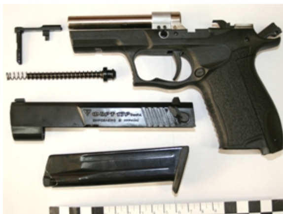
Іл. №5: Зображення предмета схожого на пістолет, наданого на дослідження (неповна розборка)
