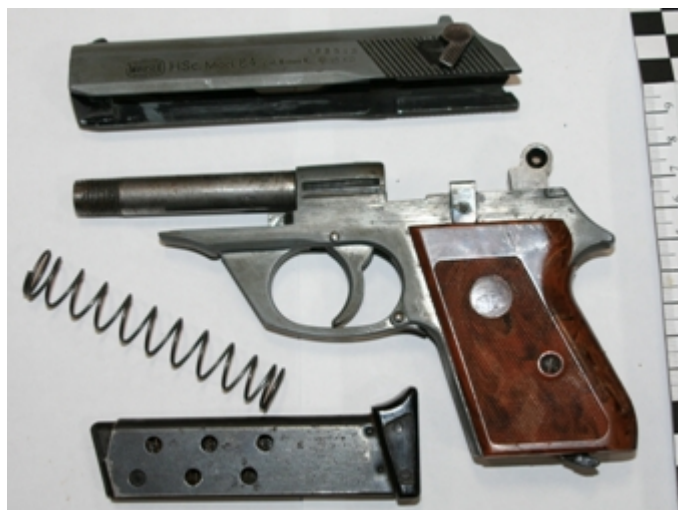
Іл. №3: Зображення предмета, схожого на пістолет, наданого на дослідження, після неповної розборки
