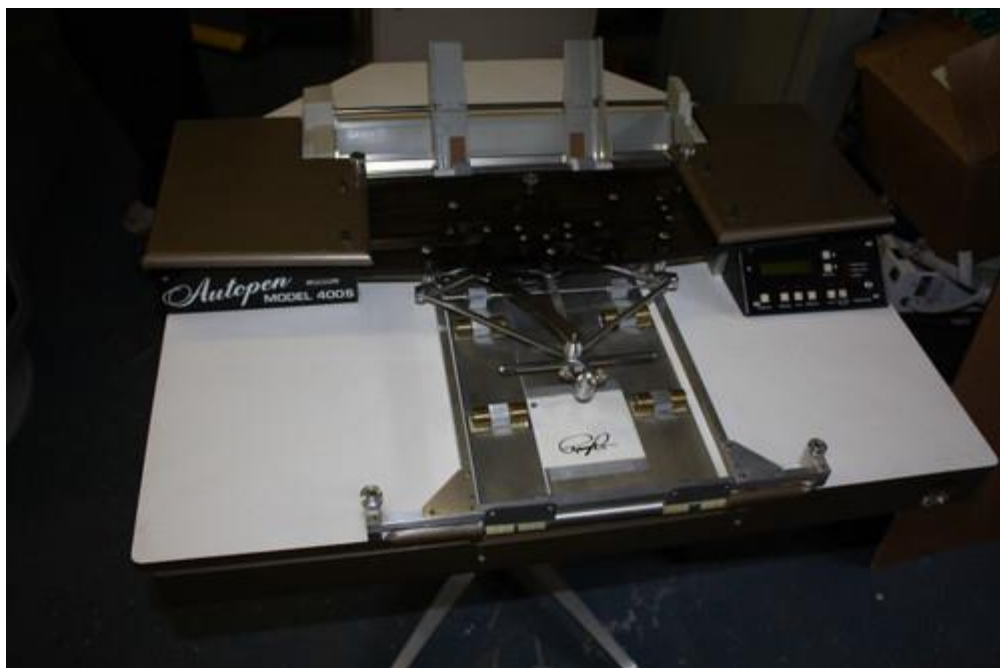
Мал. 1. Прилад для механічного нанесення підпису «Autopen Model 400S»
