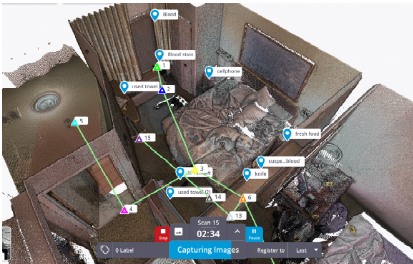
Приклад відтворення за допомогою системи лазерного 3D-сканування місця вчинення кримінального правопорушення у готелі. Об'єкти доказів ідентифікуються в хмарі точок відносно один одного, весь номер відображений у 3D форматі.
