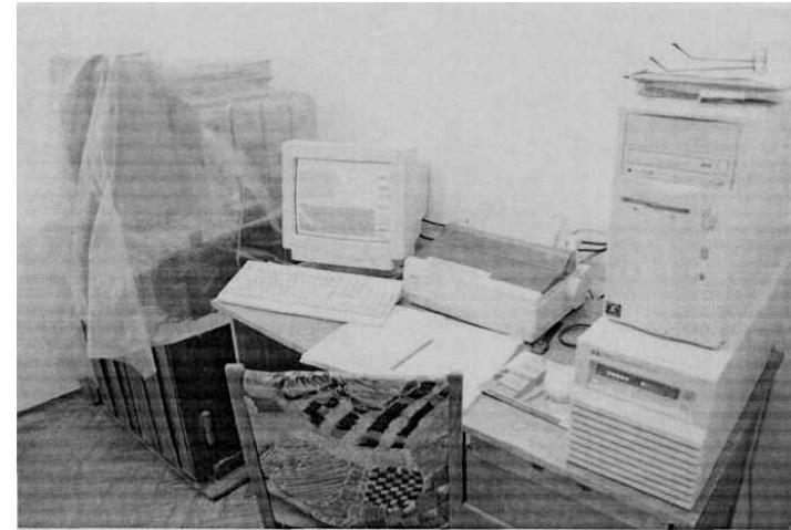
Рис. 8.2. Типовий вигляд лабораторного \gamma -спектрометра з напівпровідниковим детектором, що знаходиться в комбінованому захисті
