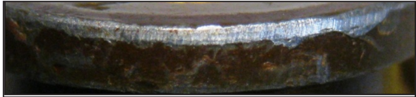
Рис. 11. Слід чашки затвора на денці однієї з гільз, стріляних у режимі одиночного вогню
