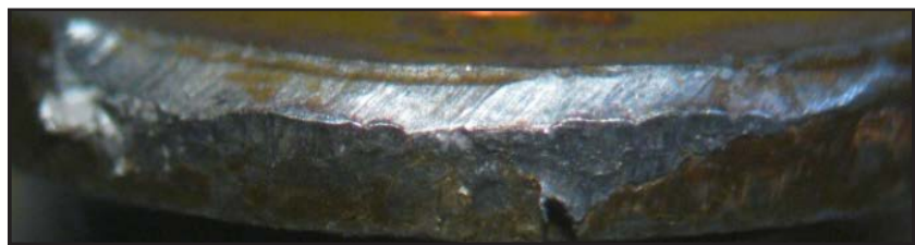
Рис. 12. Слід чашки затвора на денці однієї з гільз, стріляних у режимі автоматичного вогню
