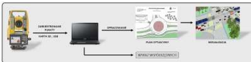
Рис. Алгоритм функціонування системи eSURV, від виконання вимірів до масштабного або ситуатійного плану у форматі 2D/3D [5].
