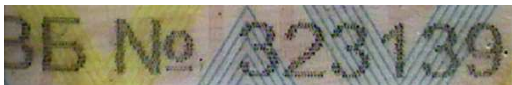
Рис. 2. Збільшене зображення елементів серійного номера бланка посвідчення водія, які нанесені способом лазерного гравіювання
