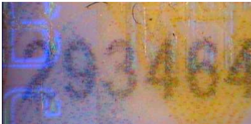
Рис. 1. Збільшене зображення фрагмента бланка посвідчення водія, яке відтворено струменевим способом за допомогою знакодрукуювальної техніки
