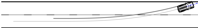
Зображення 1. Графічний результат моделювання руху автомобіля «Mitsubishi Pajero» 2005 р.в. після заклинювання лівого переднього колеса на швидкості 60 км/год.
