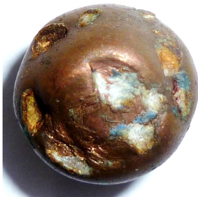
Зображення 8. Форма передньої частини кулі та відображення на ній слідів при ударі їх об перешкоду, під кутом близьким до 80°.
