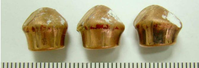
Зображення 5. Форма куль при ударі їх об перешкоду під кутом близьким до 30°.
