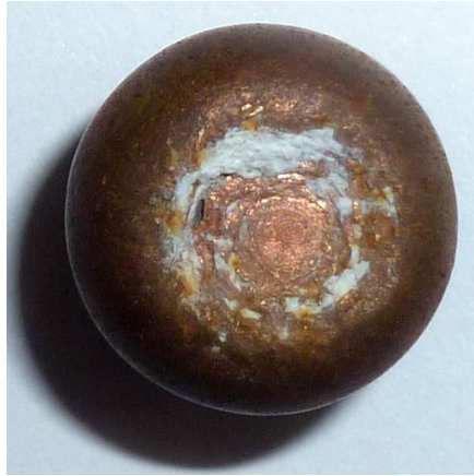
Зображення 9. Форма передньої частини кулі та відображення на ній слідів при ударі їх об перешкоду, під кутом близьким до 90°.
