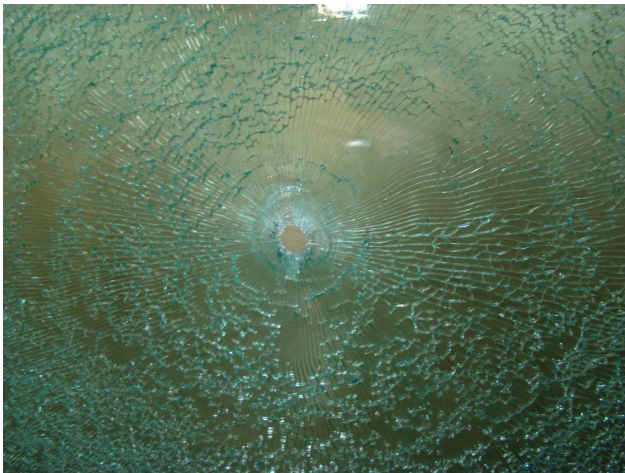
Зображення 2. Слід вогнепального пошкодження на боковому склі автомашини (загартоване скло).
