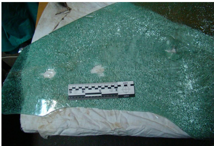
Зображення 4. Сліди вогнепальних пошкоджень на загартованому автомобільному склі праворуч – перше, в центрі – друге, ліворуч - третє.
