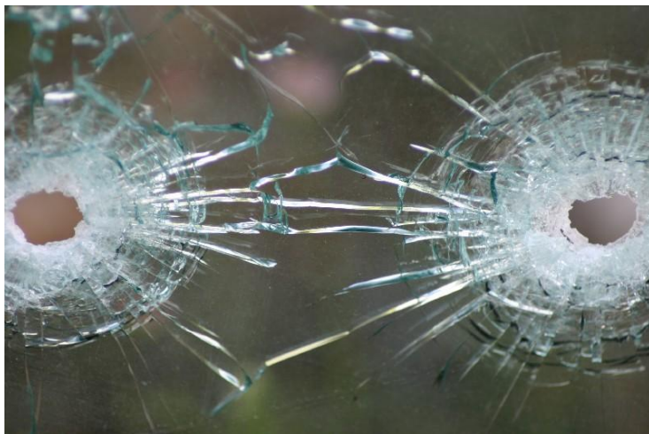
Зображення 3. Сліди вогнепальних пошкоджень на лобовому склі автомашини.
