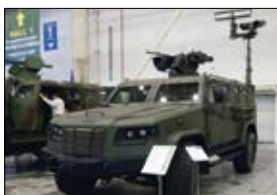
Комплекс наземної розвідки і радіоелектронної боротьби «Джеб» на ББМ «Козак-2М»
