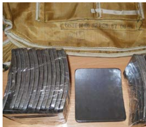
Комплект титанових пластин з 6Б3ТМ. Фото з Інтернету
