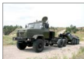
Евакуатор КраЗ-6333РЕ для евакуації бойової техніки масою до 30 т
