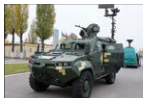
ББМ «Тритон-1» з комплексом дистанційного керування модулем, пошукової системи, системи ідентифікації цілей і передачі інформації
