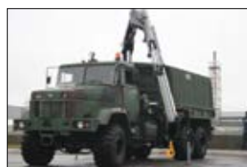
КраЗ-6322-056 – ремонтно-евакуаційна машина с гідравлічним краном
