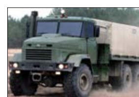
ББМ КрАЗ-6322НМРV-A (з бронюванням кабіни і паливних баків)
