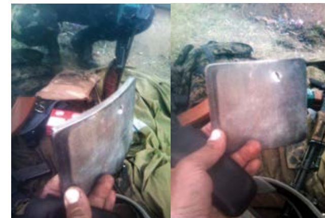
Прострілена під час тренування титанова пластина під час блокади Слов'янська-1. Фото автора
