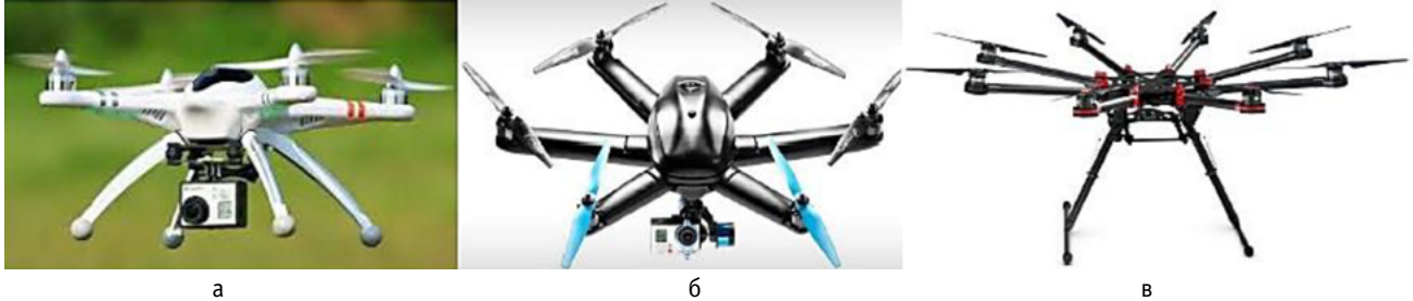
Рис. 3 Загальний вигляд конструкцій БПЛА типу «коптер»: а – квадрокоптер; б – гексокоптер; в – октокоптер (Sakovskiy et al., 2022)
