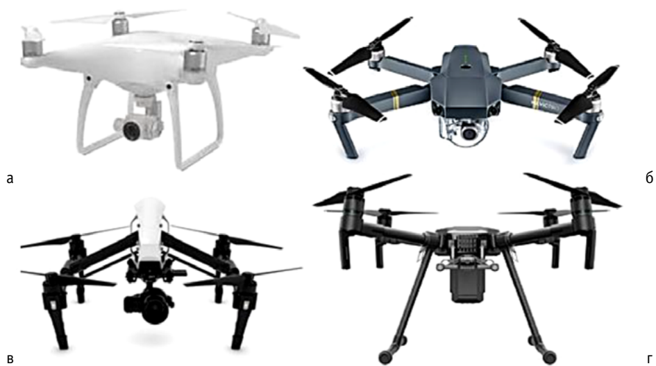
Рис. 4 Загальний вигляд конструкцій квадрокоптерів компанії DJI: а – Phantom; б – Mavic; в – Inspire; г – Matrix (Obzor kvadrokopteroiv DJI: Mavic Pro, Inspire, Phantom 4, n.d.)
