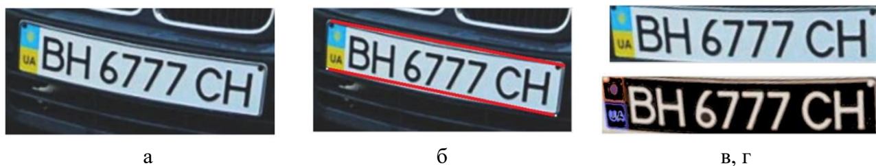
Рисунок 3.26 – Виявлення та обробка номерного знаку транспортного засобу
