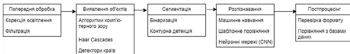
Рисунок 3.25 – Етапи процесу розпізнавання номерних знаків транспортних засобів
