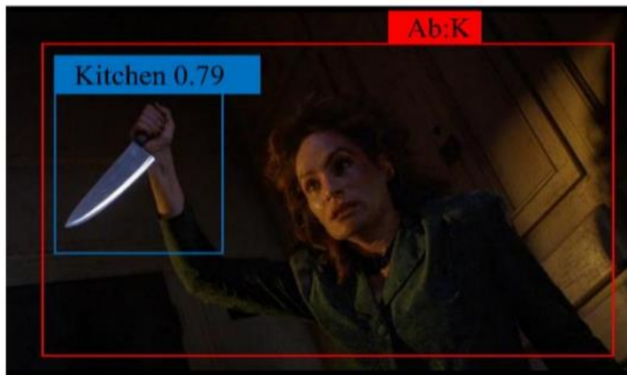
Рисунок 3.21 – Приклад виявлення системою зброї та визначення її класу [50]
